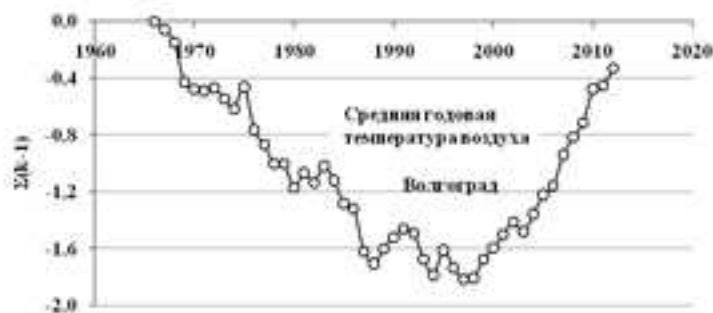
Рис. 2. Нормированные разностные интегральные кривые средней годовой температуры воздуха ( k = T_{cp.год} / \bar{T}_{cp.год} , где T_{cp.год} – средняя годовая температура воздуха, \bar{T}_{cp.год} – средняя многолетняя годовая температура воздуха)
