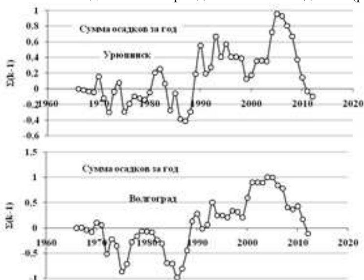
Рис. 3. Нормированные разностные интегральные кривые сумм осадков за год ( k = P_{год} / \bar{P}_{год} , где P_{год} – сумма осадков за год, \bar{P}_{год} – средняя многолетняя сумма осадков за год)
