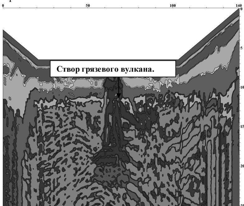
Рис.3 Георадарный разрез структуры грунта в долине грязевых вулканов (п. Веселовка, Таманский район, Краснодарский край), июль 2004 года (профиль №2).
