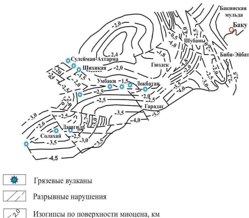
Рис. 2. Структурная карта Шамахино-Гобустанского и Апшеронского нефтегазоносных районов по кровле миоценовых отложений.
