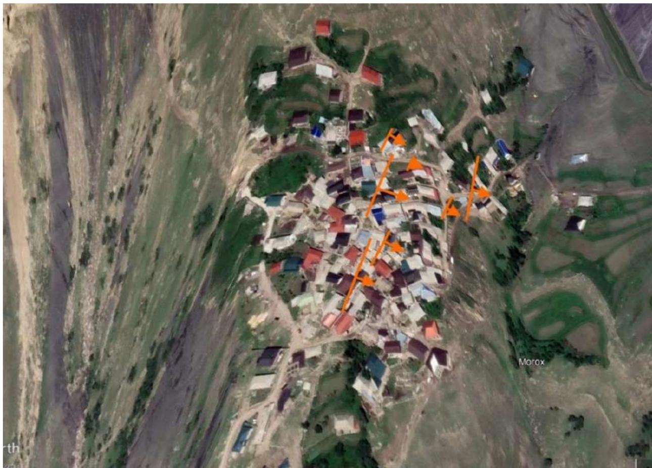
Рис. 4. Село Могох. Трещины и направления смещений.
