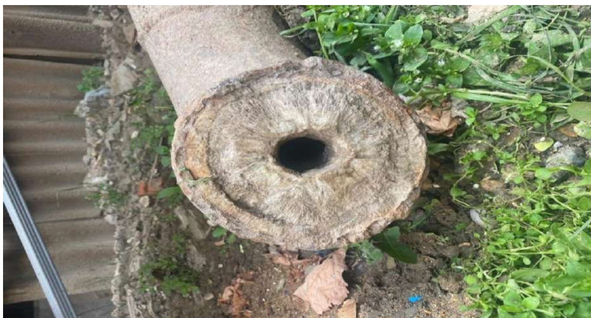
Рисунок 1. Солеотложение на геотермальном оборудовании
