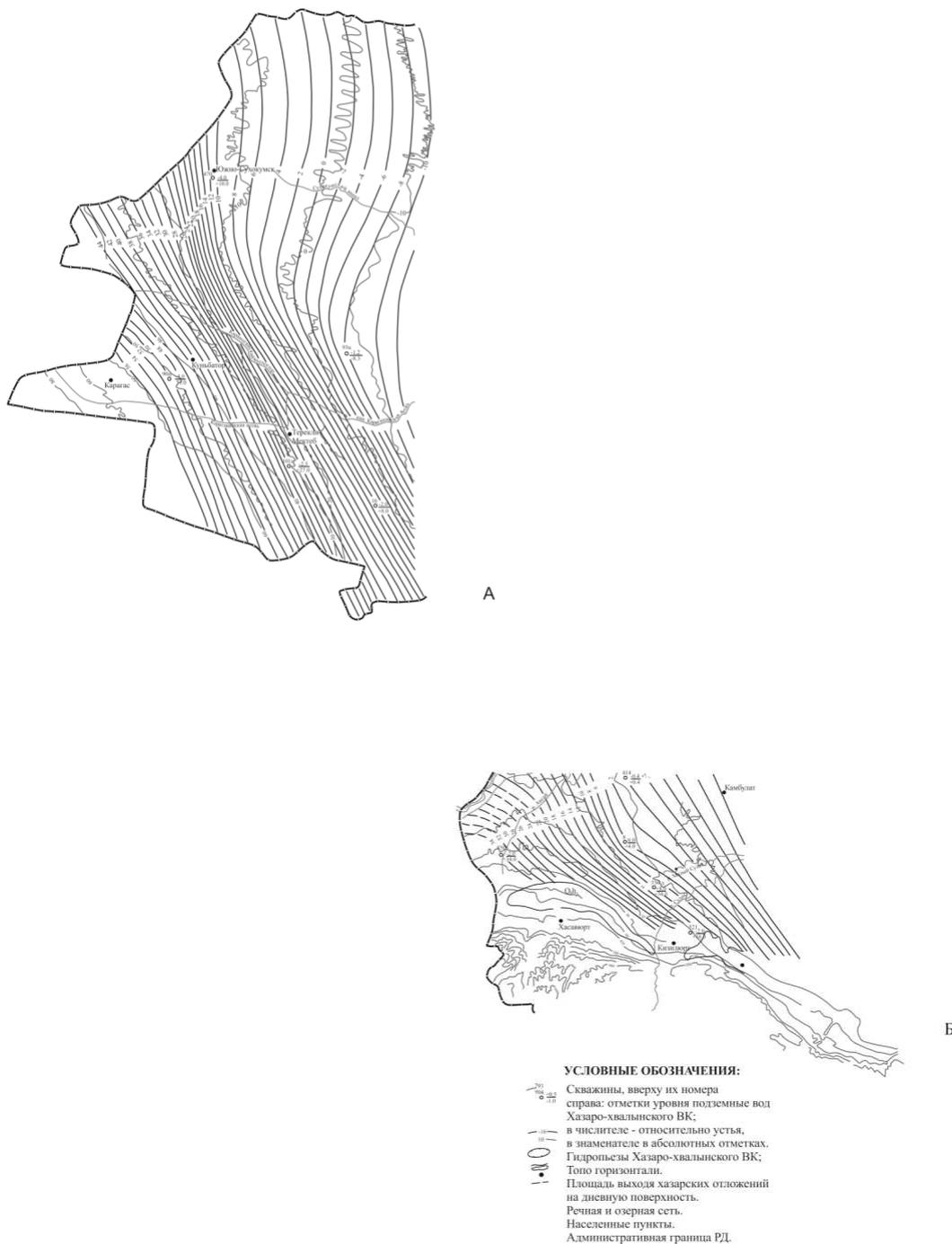
Рис. 3 (А, Б). Карта гидроизопьез хазаро-хвалынского водоносного комплекса.
