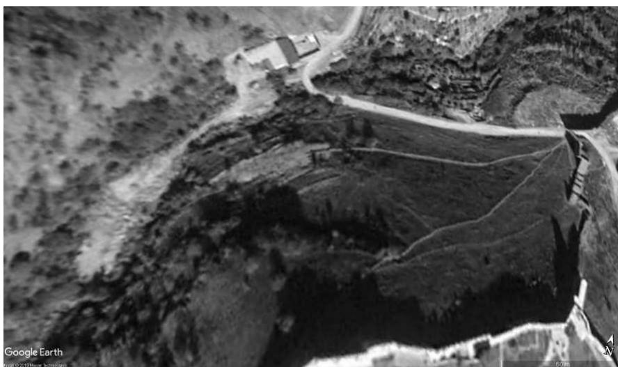
Повторная засыпка тальвега балки. Формирование нового селеопасного очага.
