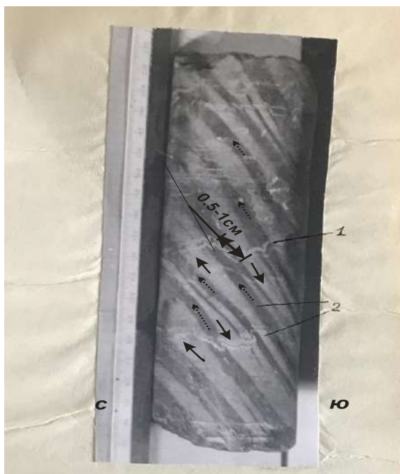
Рис.2. Пластическое течение пород. 1- истинная, 2- ложная параллельная сланцеватости слоистость (фото из отчета А.И.Гусева «Крупномасштабное картирование масштаба 1:25000 в Хнов-Борчинском рудном поле. 1982г»).
