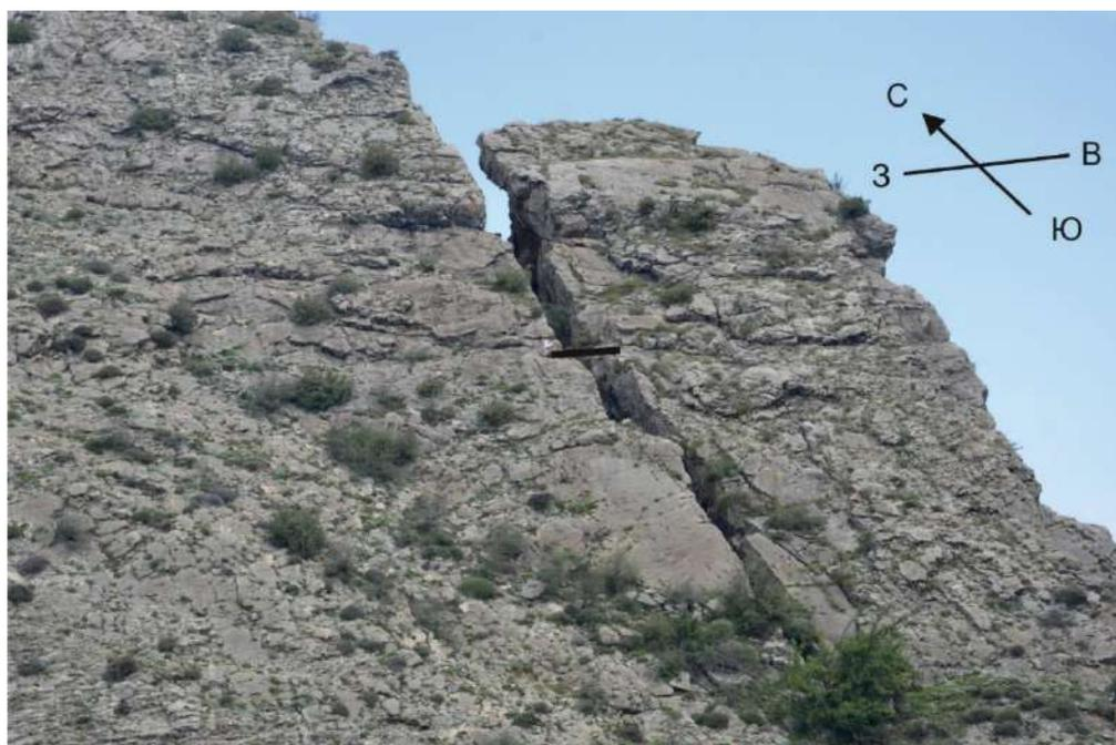
Рис. 1. Фото отрывной трещины сверху (место установки струнного датчика и лазерной линейки на трещине показано жирной линией)
