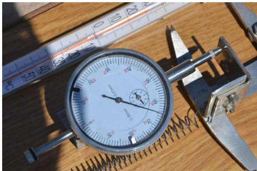
Рис. 2. Фото струнного регистратора (рядом термометр для измерения температуры атмосферы)
