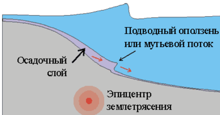
Рисунок 5. Схема образования подводного оползня или мутьевого потока.
