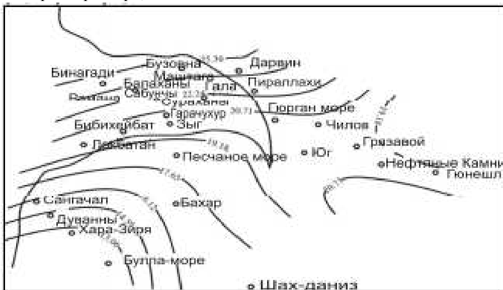
Рис. 4. Тренд значений пористости в песчаных коллекторах ПТ (поверхность третьей степени) [1]
